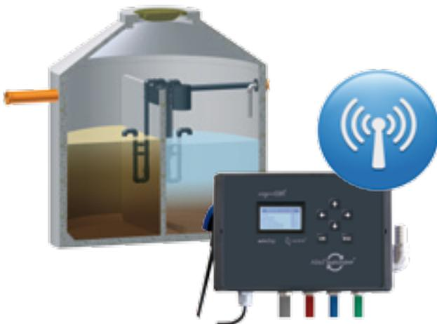
Die batchpur Kleinkläranlage hat die bauaufsichtliche Zulassung und Bestätigung, dass die Anlage betreiberunabhängig per Datenfernüberwachung durch externe Fachkräfte betrieben werden darf. Notwendig ist dafür eine Telemetrie-Steuerung, die den täglichen Statusbericht und alle relevanten Daten an das easy...con-Webportal zur Auswertung und Dokumentation übermittelt.
